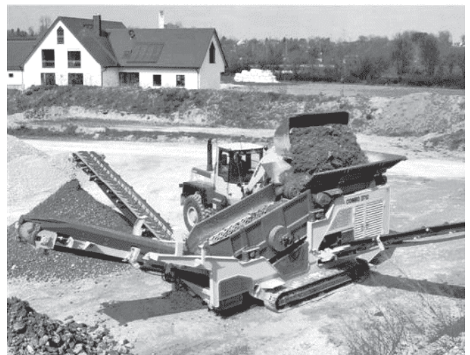
Macchina vagliatrice per la separazione delle varie matrici.
