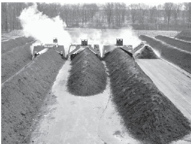
Impianto di compostaggio su platea all'aperto.
