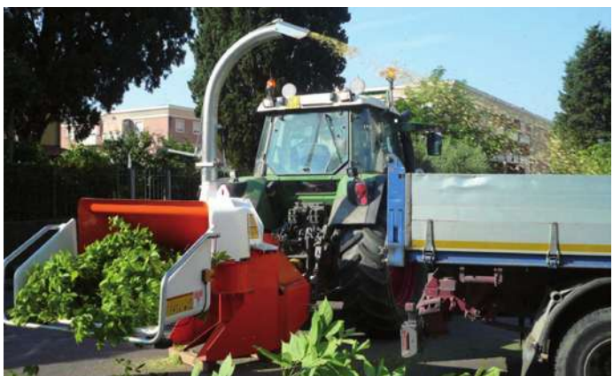
Fig. 14 - La cippatrice in azione sulla vegetazione (tronchi, rami, radici, fronda)
